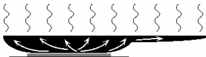
Fig. 5 – Calor conduzido através da frigideira até ao cabo
